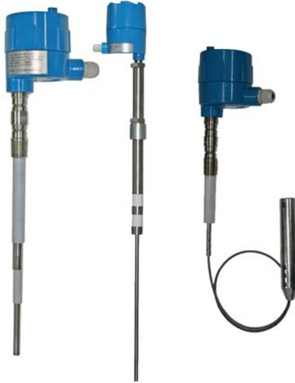
KGD-200 系列射频导纳物位开关采用先进的射频导纳技术，克服了电容式物位开关不能消除导电棒挂料影响的缺陷。仪表运行可靠，各项技术指标均达到国际同类产品水平，广泛适用于液体、浆体、粉尘、料位以及两种液体界位的报警与控制。此外，产品增加了现场工作状态指示，是一种性能价格比较高且相当稳定可靠的物位开关。高温高压型可以应用在800℃、25MPa工作场合。
