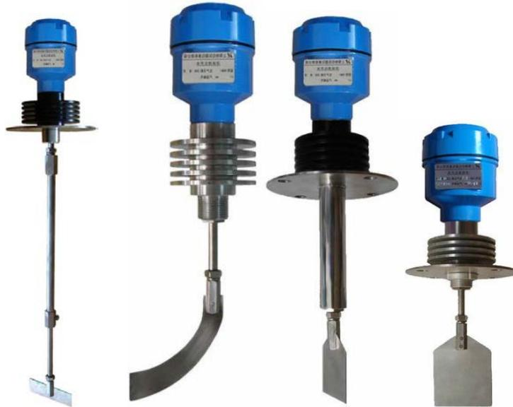
GDZK 系列阻旋式料位开关适用于各种敞口容器内料位的控制，仪表采用特殊油封设计，具有双层防尘，并有进口离合器装置保护马达，工作可靠，使用维护方便，广泛用于水泥、化工、食品、采矿、塑料、陶瓷等工业行业，接触物料后，马达会停止转动，同时输出一组无源触点信号。是一种较理想的简易料位控制仪表。
