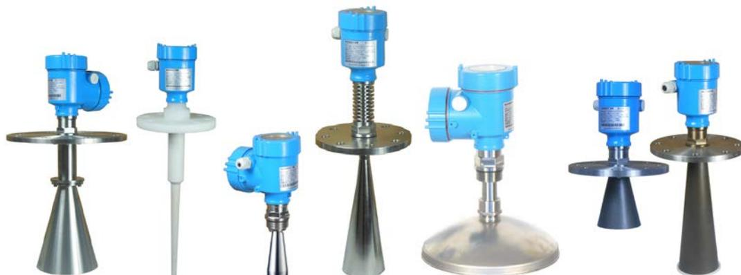
适用于各种过程条件复杂的容器、储罐、仓料等，且不受被测介质物理特性变化影响的外部测量，两线制或四线制技术，适用于防爆场合，非接触式连续测量的脉冲型物位计最大测量距离 70m。
