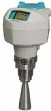
SITRANS LR250 是两线制仪表，25GHz 脉冲雷达液位变送器，连续测量储罐和过程罐中的液体和浆液，适应高温和高压，量程为 20m。
