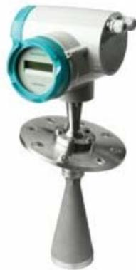
SITRANS LR460 雷达物位计是 4 线制 24 GHz FMCW 雷达变送器，具有极高的信噪比，测量固体料位达 100 m 量程，先进的信号处理方法，它是极度粉尘工况的理想解决方案。主要应用：大量程粉尘应用，水泥粉尘，飞灰仓，煤粉，粉末，谷物，塑料粉末、氧化铝粉末仓，
