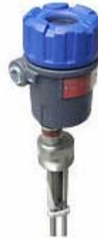
Eclipse 增强型 705 和 Horizon 普通型 704 是采用最新的导波雷达（GWR）技术的两线制、回路供电、24VDC 的液位变送器。Eclipse 变送器能匹配所有种类的导波杆，并提供更强的可靠性。先进的 Eclipse 变送器所具有的性能远远优于许多采用传统技术的变送器。该产品在工业上首次采用了先进的专利外壳设计，它是把接线室和电子线路室分别安排在同一平面上，平面倾斜的角度更适合于接线，组态和观察显示数据。Eclipse 支持 FDT/DTM 标准，同时也支持 PACTware™，一个用于组态和趋势判断的 PC 软件。
