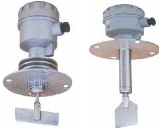
GDZK 系列阻旋式料位开关适用于各种敞口容器内料位的控制，仪表采用特殊油封设计，具有双层防尘，并有进口离合器装置保护马达，工作可靠，使用维护方便，广泛用于水泥、化工、食品、采矿、塑料、陶瓷等工业行业，接触物料后，马达会停止转动，同时输出一组无源触点信号。是一种较理想的简易料位控制仪表。
